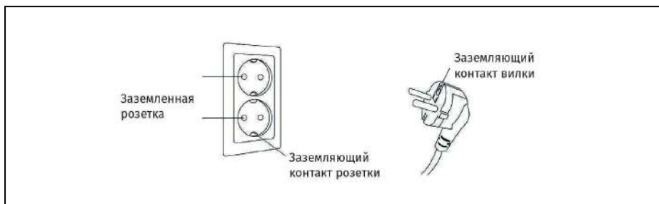
Рисунок 21 — Правильное заземление массажного кресла
