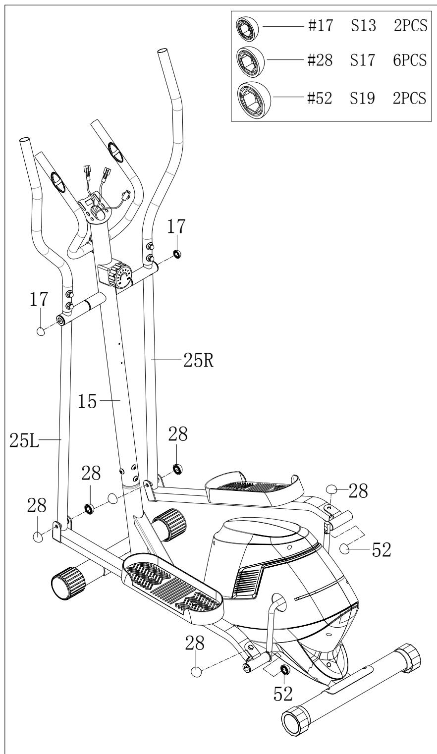
Прикрепите торцевую крышку (17) к соединению нижнего поручня (25L / R) и поручня (17). Прикрепите торцевую крышку (28) к соединению нижнего поручня (25L / R) и педальной трубы (42L / R). Прикрепите торцевую крышку (8) и торцевую крышку (52) к соединению педальной трубы (42L / R) и рычага.
