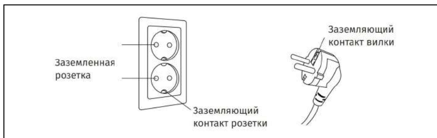
Рисунок 10 – Правильное заземление массажного кресла.
