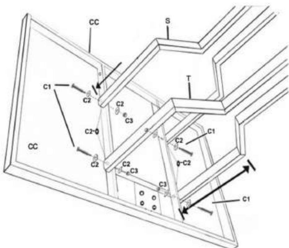
Установите опорные балки щита S, T на стойку W
