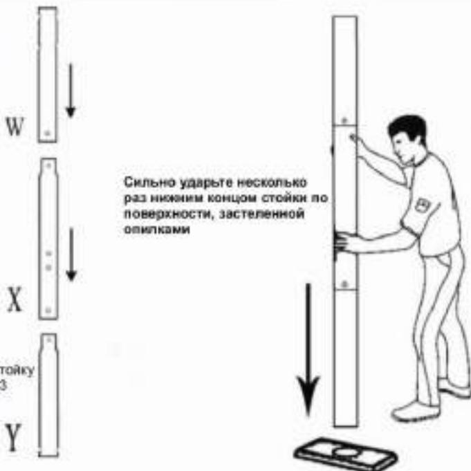
Зафиксируйте соединения стоек при помощи 3 комплектов болтов G1, G2 и G3
