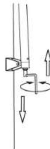
Рукоятку (R) можно снять. Она крепится небольшим болтом (Z1), расположенным на конце механизма регулировки (Z).
