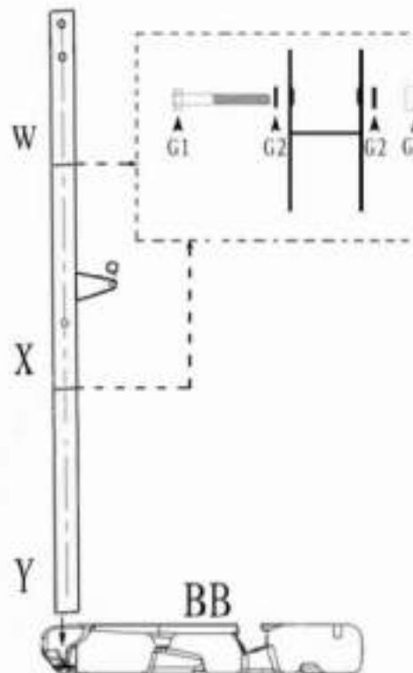
Вставьте нижнюю стойку Y в отверстие спереди основания BB. Перед выполнением следующего этапа удостоверьтесь, что кронштейн Q повернут назад.
