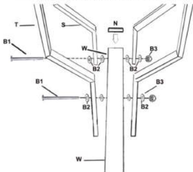
Установите механизм регулировки Z, как показано на рисунке
