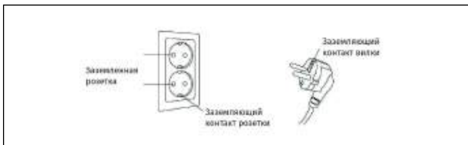
Рисунок 33 — Правильное заземление массажного кресла
