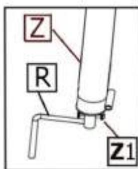
Рукоятку (R) можно снять. Она крепится небольшим болтом (Z1), расположенным на конце механизма регулировки (Z).
