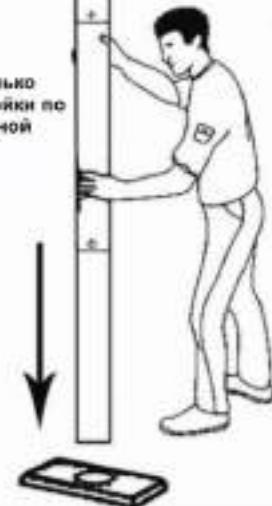
Зафиксируйте соединения стоек при помощи 3 комплектов болтов G1, G2 и G3.
