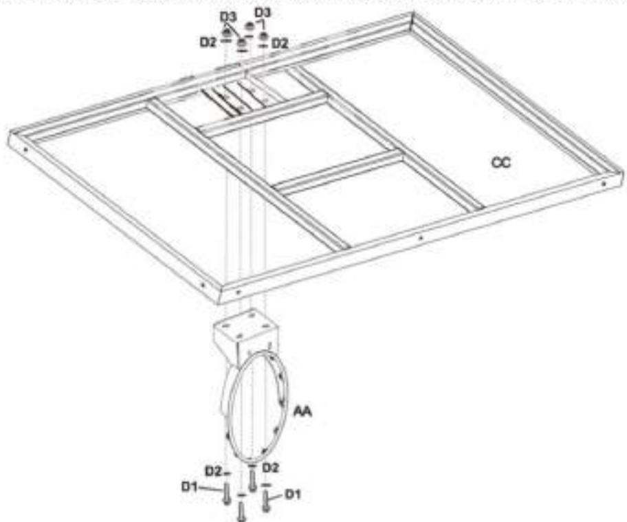
Установите опорные балки щита S, T на заднюю поверхность щита CC, как показано на рисунке
