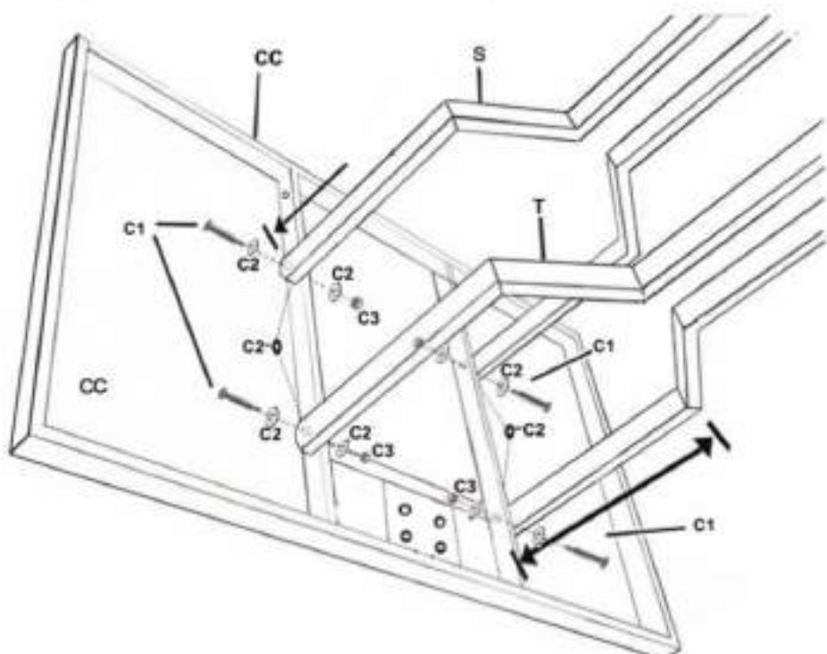
Установите опорные балки щита S, T на стойку W
