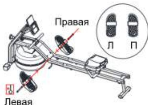
9. Плотность прилегания ремешка можно регулировать с помощью пластиковой застежки на ножном ремешке.
