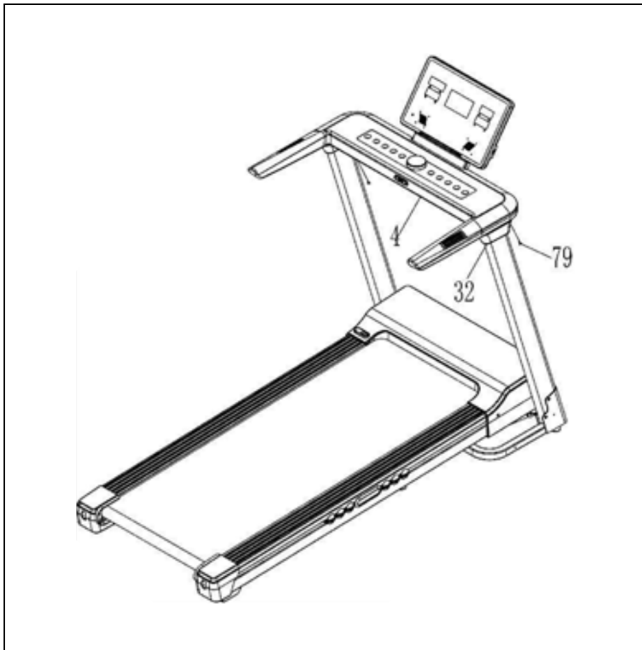
Рисунок 4 — Установка декоративных заглушек под консолью
