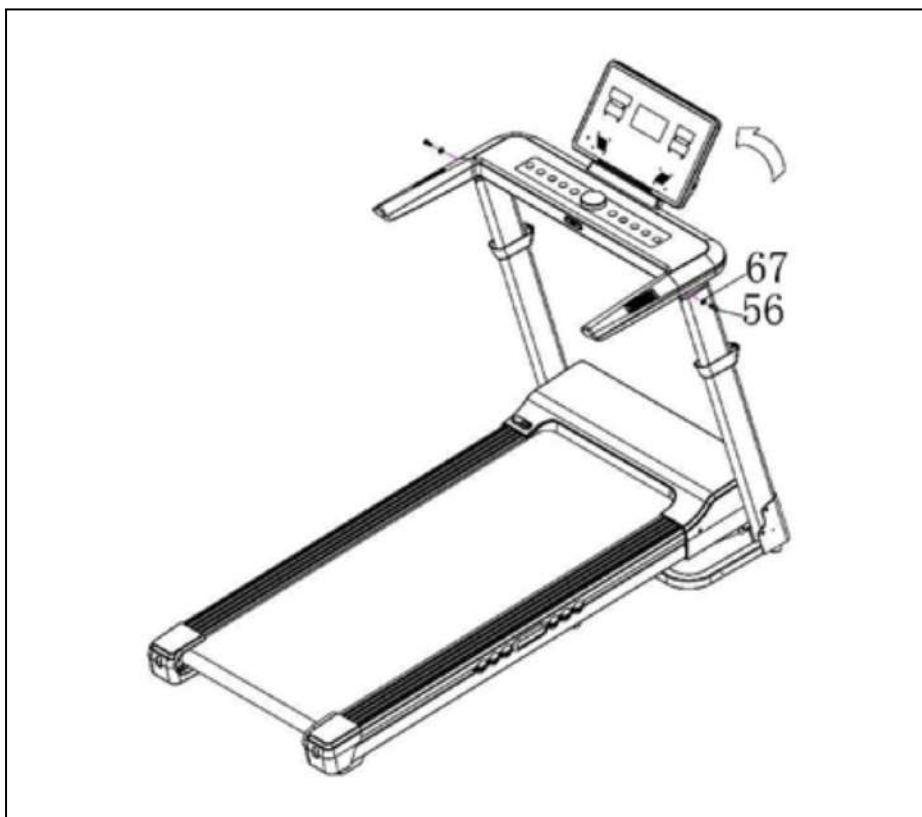
Рисунок 3 — Установка консоли беговой дорожки
