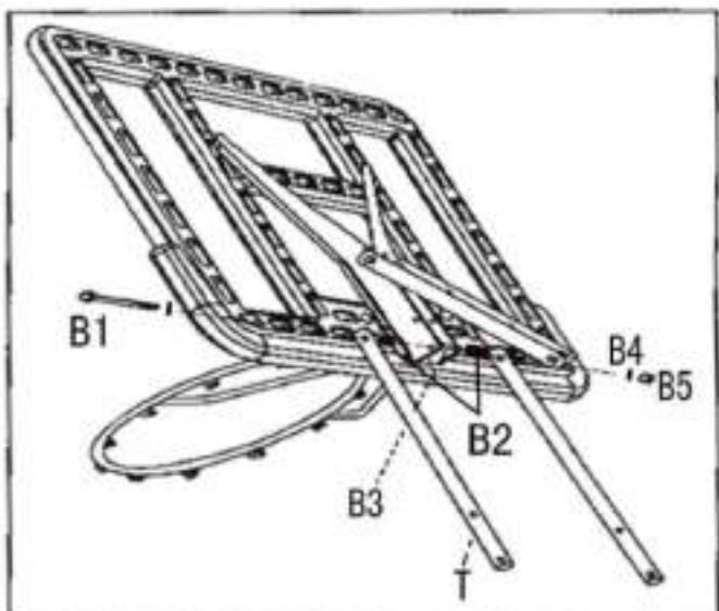
Затяните гайку таким образом, чтобы она располагалась на одном уровне с болтом.
