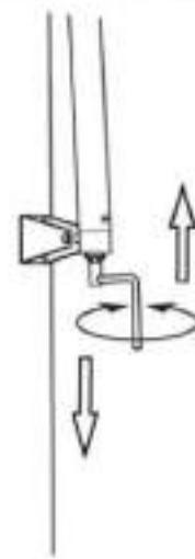
Рукоятку (R) можно снять. Она крепится небольшим болтом (Z1), расположенным на конце механизма регулировки (Z).
