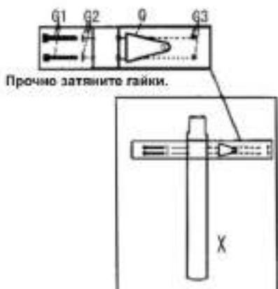
Вставьте верхнюю часть нижней стойки в нижнюю часть средней стойки.
