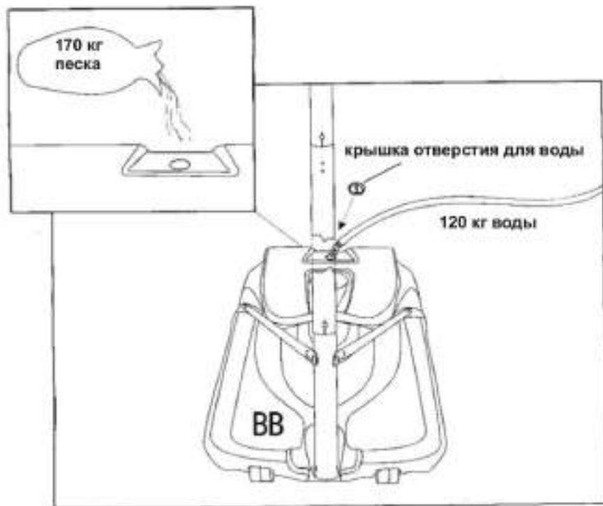
В целях безопасности рекомендуется наполнять основание песком, а не водой. При возникновении течи, вода может вытечь незаметно, в результате чего стойка может упасть, что может привести к травмированию и/или смерти или повреждению имущества. Устанавливайте основание только на ровную поверхность, очищенную от острых предметов, которые могут проколоть основание.
