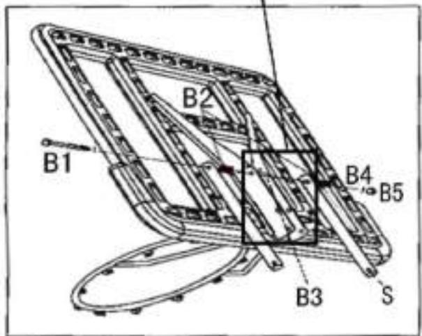
Затяните гайку таким образом, чтобы она располагалась на одном уровне с болтом.
