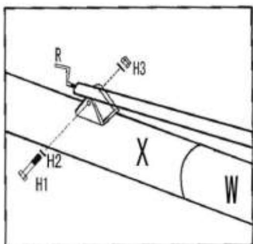
Прочно затяните гайки.
