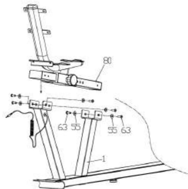
Прикрепите подседельную трубку (80) к основной раме (1) с помощью винтов (63), шайб (55) и нейлоновых гаек (56).
