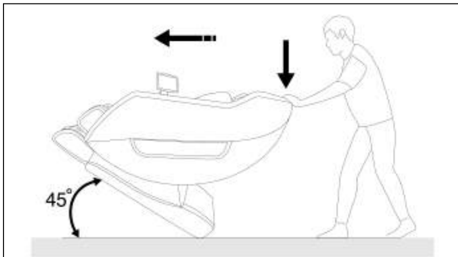
Рисунок 19 — Перемещение массажного кресла с помощью транспортировочных роликов
