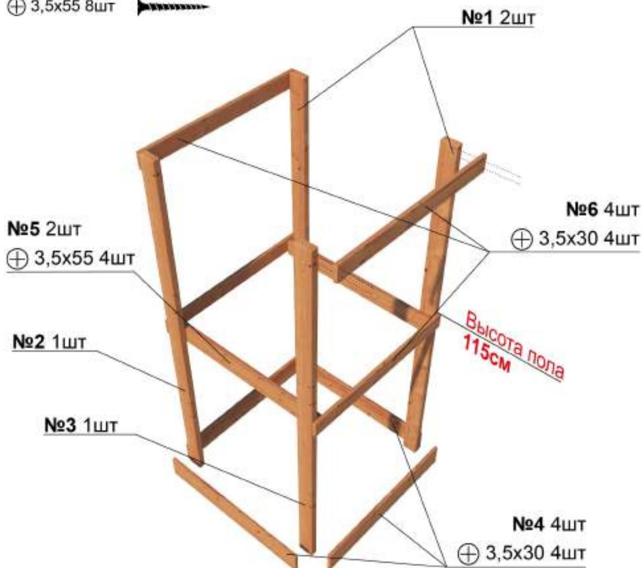
\*Расположить детали № 2и №3 таким образом, чтобы сквозные отверстия, расположенные на этих деталях, находились в верхней части конструкции городка.
