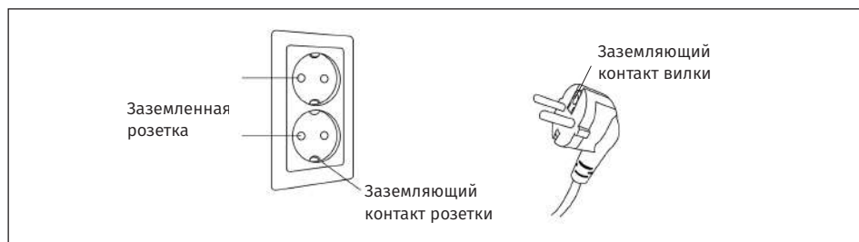
Рисунок 9 – Правильное заземление массажного кресла
