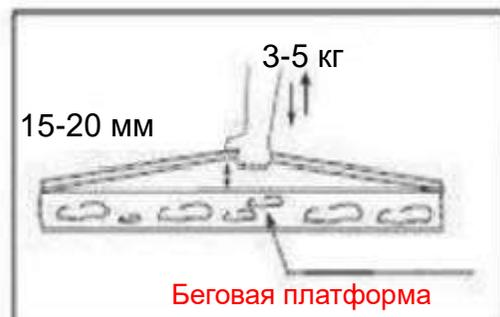
1. Чтобы затянуть полотно, поверните регулировочные винты на левой и правой крышках задней панели по часовой стрелке на четверть оборота (90 градусов) за раз.
