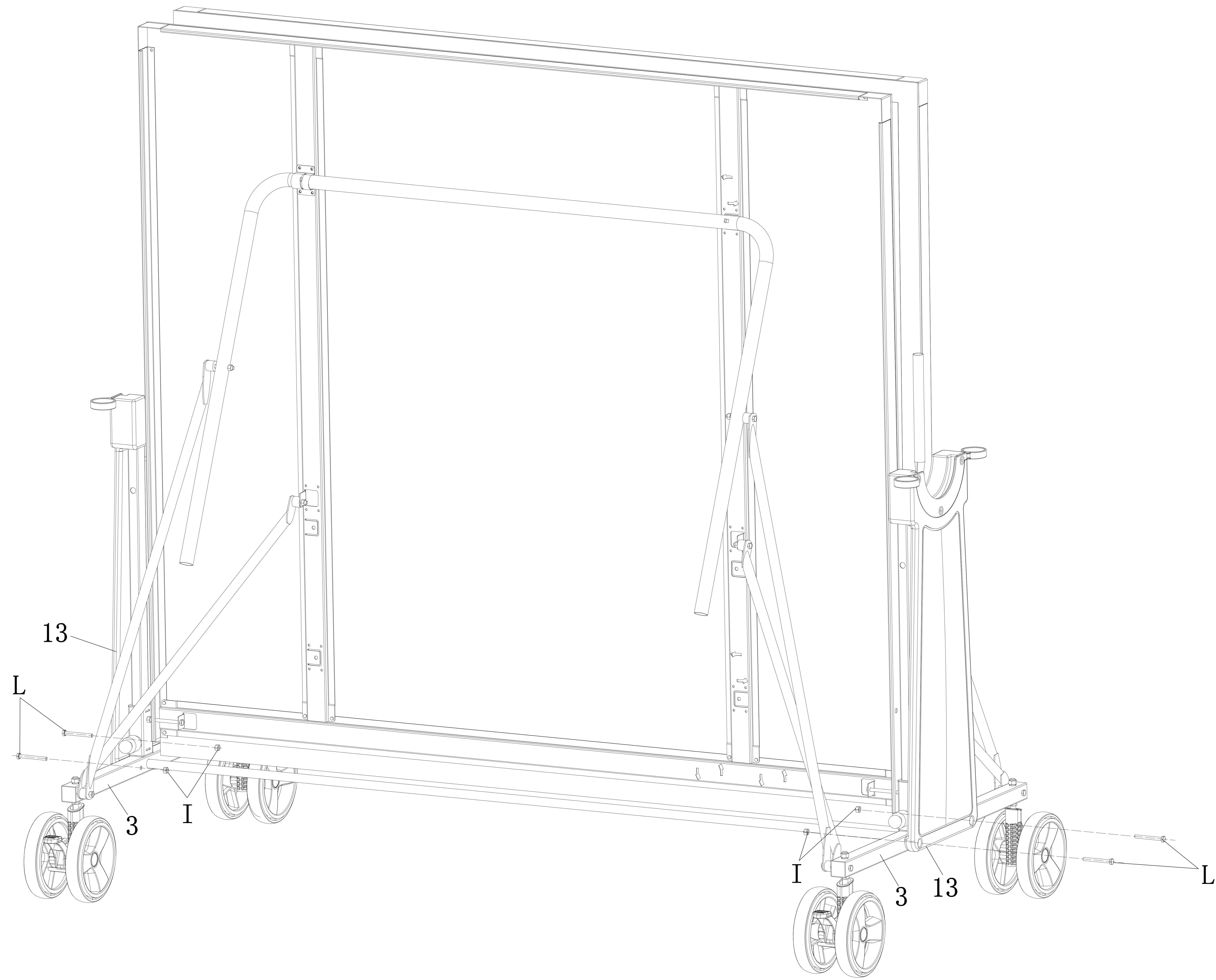
**14** Для открытия стола требуется, чтобы два человека одновременно потянули деталь 16, поворачивая и опуская стол
