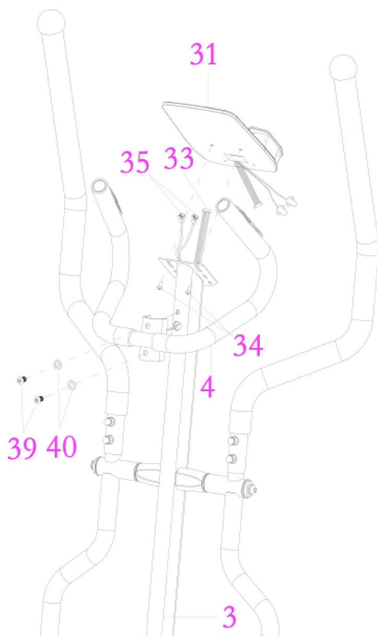
**5. Установка неподвижного поручня и компьютера**
