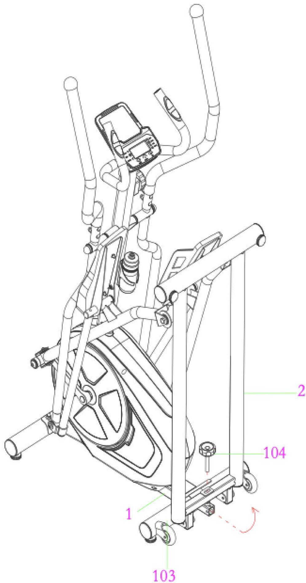
Открутите ручку M12\*65 (104) и поднимите заднюю опору (2), как показано на рисунке. Затем с помощью ручки M12\*65 (104) закрепите заднюю опору (2) на заднем стабилизаторе (103).
