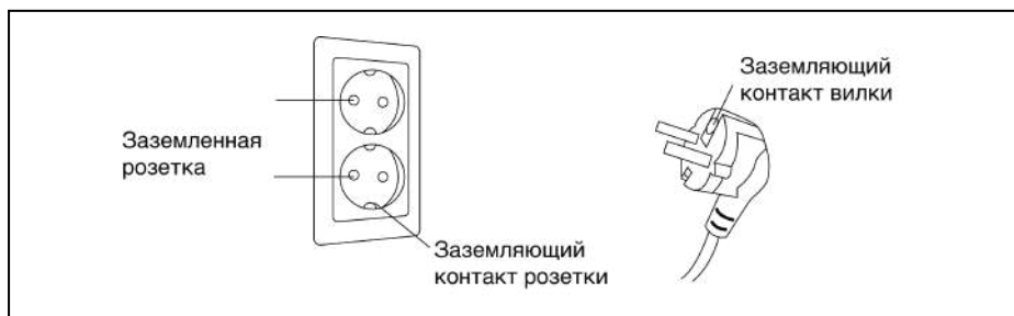
Рисунок 10 — Правильное заземление массажного кресла
