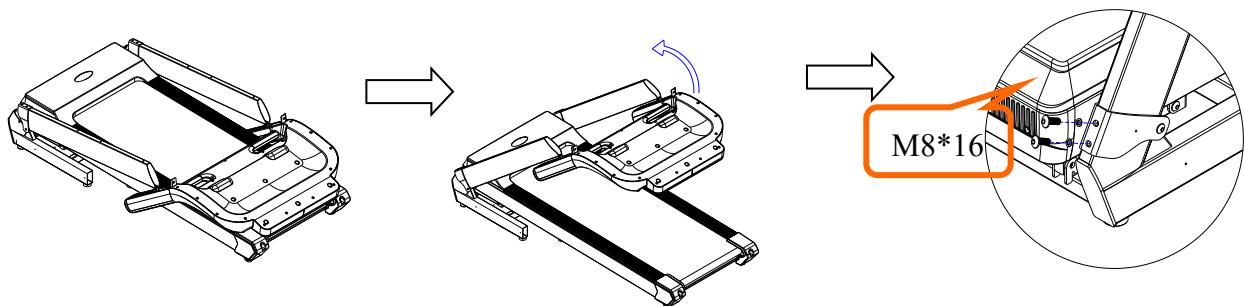
Шаг 2. Сначала поверните компьютер в направлении стоек в соответствии с методом, показанным на рисунке, так, чтобы железная пластина на нижнем конце компьютера совпала со стойками. Затем закрепите компьютер на стойках с помощью гаечного ключа, винтов M8 \* 16 с полукруглой головкой и плоских прокладок M8. **(Внимание: Берегите руки!)**
