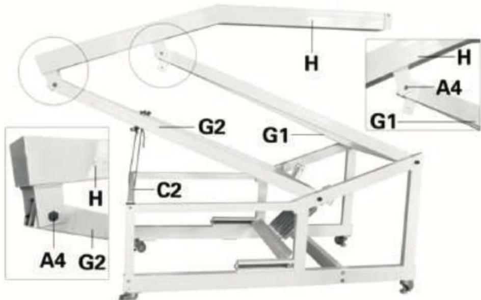
8. Оттяните заднюю скобу (G2) максимально назад и привяжите ее к верхней балке (C2) с помощью веревки. Важно! Веревка должна быть прочной. Повреждение пружины или веревки может привести к травме или смерти. С помощью 2-х винтов A4 закрепите главную стойку (H) на крепежных блоках задней (G2) и передней (G1) скобы. Надежно затяните винты.
