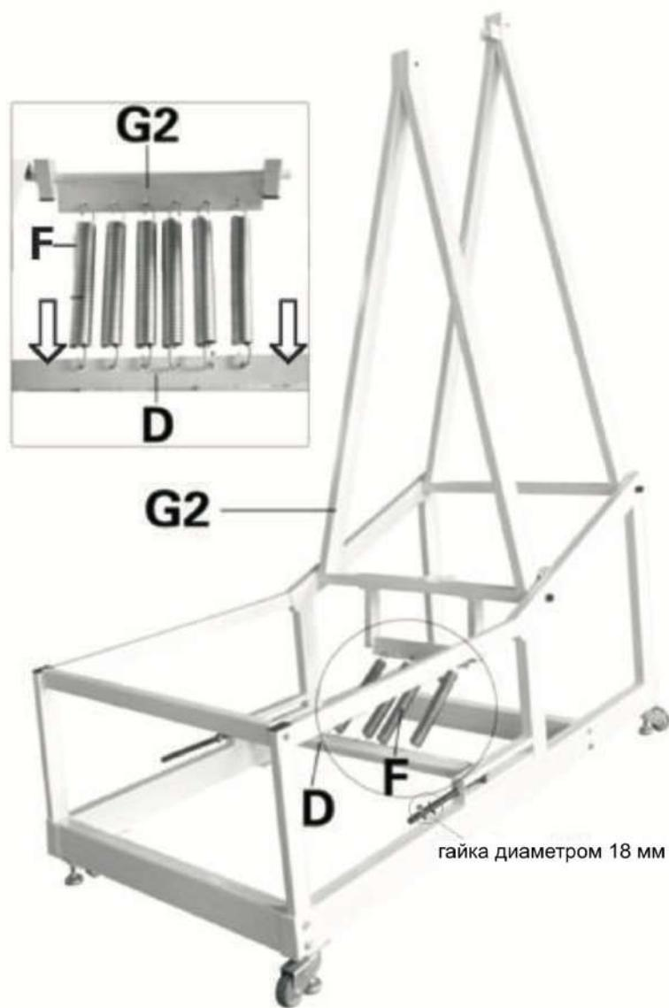
7. Установите пружины (F), как показано на рисунке: подцепите один конец пружины (F) в отверстия на задней скобе (G2), а другой - к пружинной тяге (D). Далее оттяните пружинную тягу (D) максимально назад и затяните гайку на винте (E).
