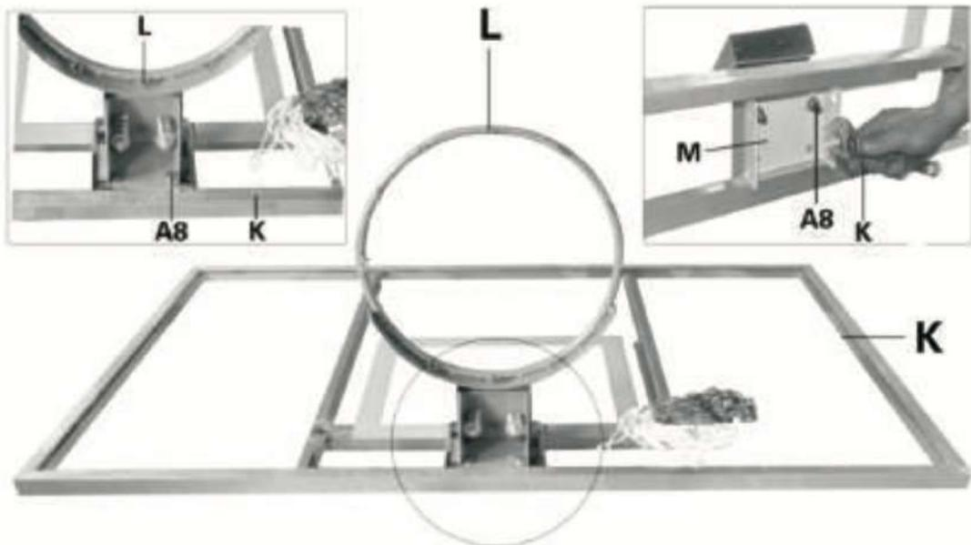
12. Выньте из кольца 2 пары винтов и пружин. Соедините вместе кольцо (L), щит (K) и установочный блок (M) с помощью 4-х винтов А8. Важно: следите за тем, чтобы отверстия на установочном блоке (M) были обращены вверх. Теперь установите на место винты и пружины на кольце (L).
