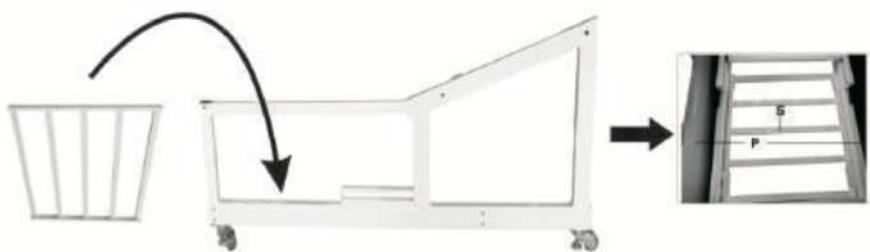
14. Установите стойку для груза (Т) на крепежных блоках опорных скоб (В), как показано на рисунке. Для сохранения устойчивого положения всей конструкции и во избежание падения щита перед началом эксплуатации на эту стойку требуется разместить груз весом 350 кг.
