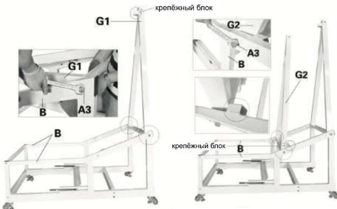
5. Установите переднюю скобу (G1) на верхнюю переднюю часть опорных скоб (B) с помощью 2-х винтов A3. Обратите внимание на то, чтобы крепежный блок был обращен назад.
