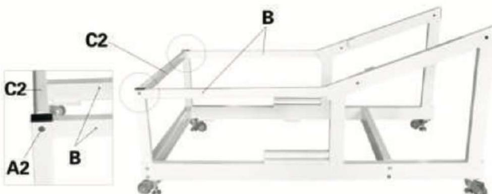
3. Закрепите верхнюю балку (С2) между опорными скобами (В) с помощью 2-х винтов А2. Внимание: на этом этапе не затягивайте винты до конца, оставляя зазор для установки тяги пружины (D) и установочного винта пружины (Е) на шаге 4.
