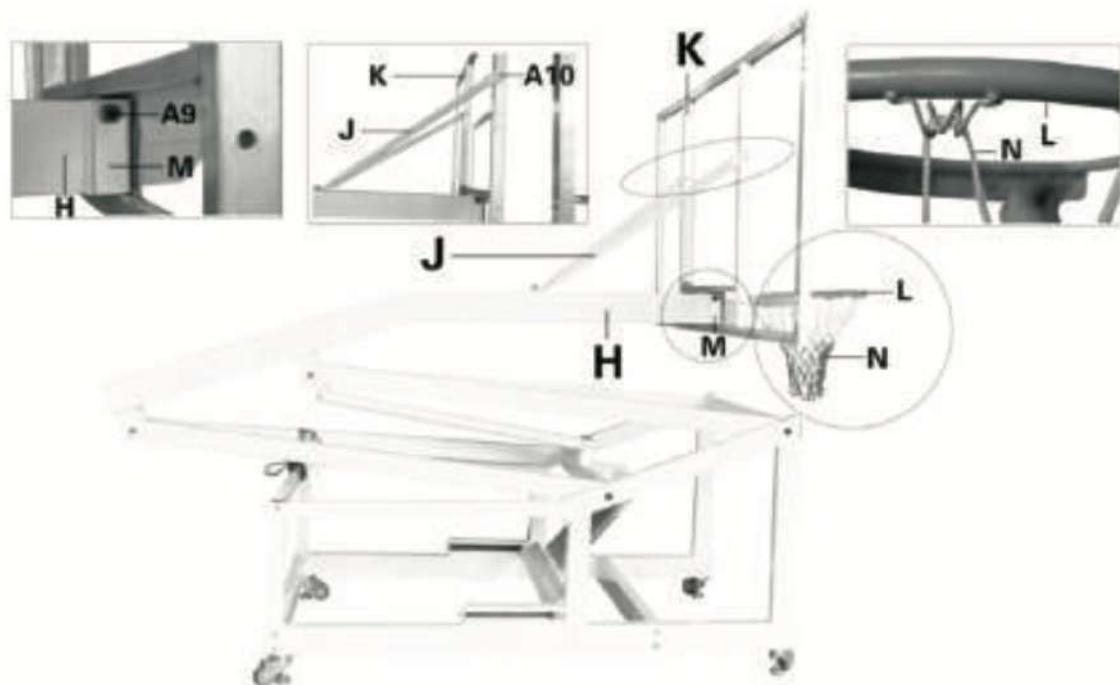
13. Приподняв конструкцию щита, закрепите установочный блок (M) на главной стойке (H) с помощью винтов А9. Далее с помощью 2-х винтов А10 закрепите обе стойки щита (J) на щите (K). Наконец, установите сетку (N) на кольцо (L).
