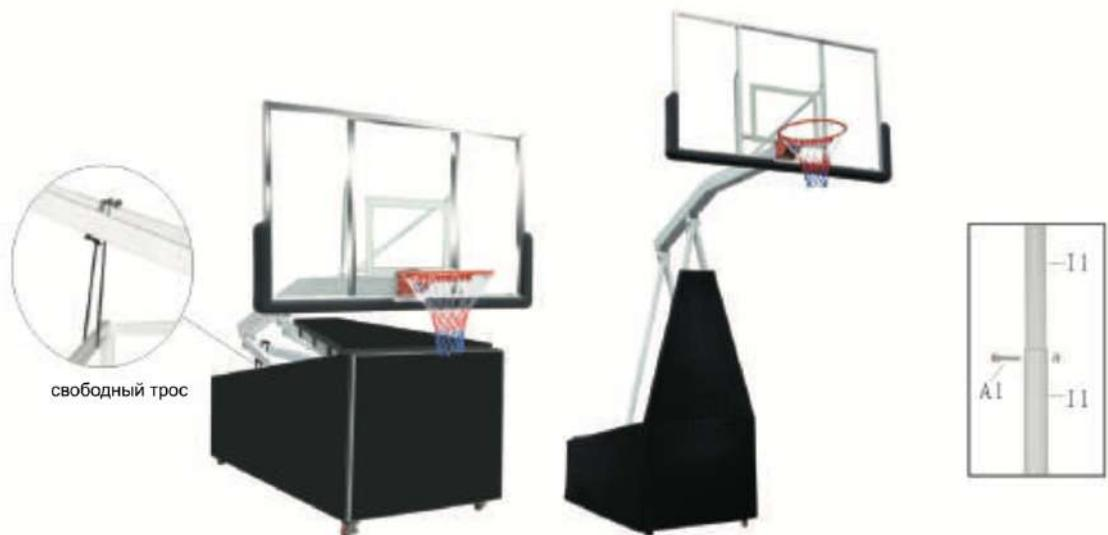
16. Медленно ослабляйте веревку, соединяющую заднюю скобу (G2) и верхнюю балку (C2), пока передняя (G1) и задняя (G2) скобы не встанут вертикально. Убедитесь, что отверстия на верхней (I1) и нижней (I2) штангах совпадают, вставьте винт A1 в одно из них для фиксации высоты баскетбольной стойки.
