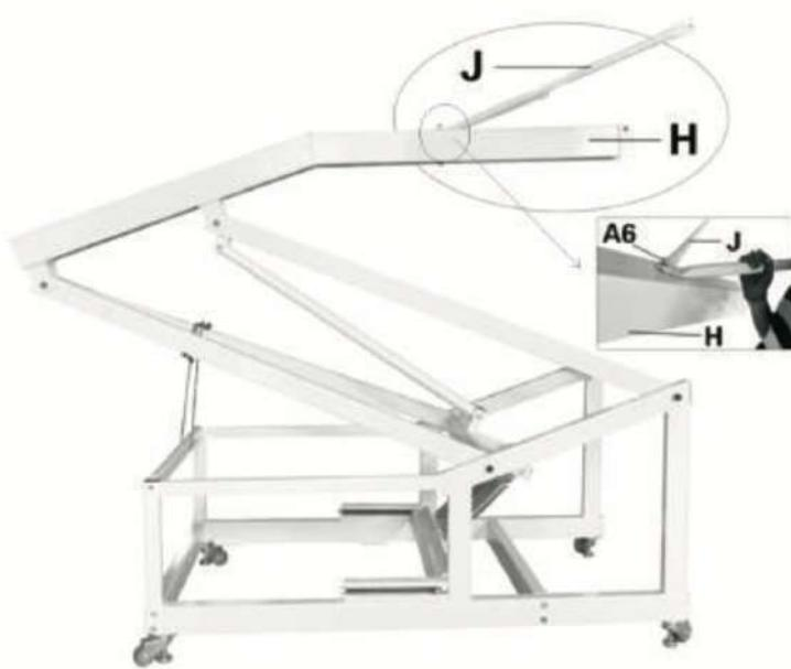
10. С помощью винта А6 закрепите длинные концы стоек щита (J) на главной стойке (H). Затяните винты А6 только после того, как другие концы стоек (J) будут закреплены на щите (K). (Важно: в комплекте поставки идут левая и правая стойки щита (J)).
