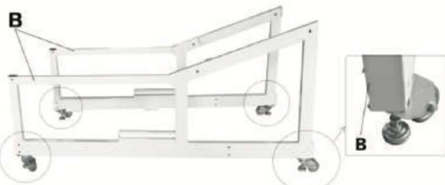
1. Установите опорные скобы (В) вертикально. Закрепите транспортировочные колеса. Для исключения подвижности конструкции во время сборки используйте фиксирующие ножки.
