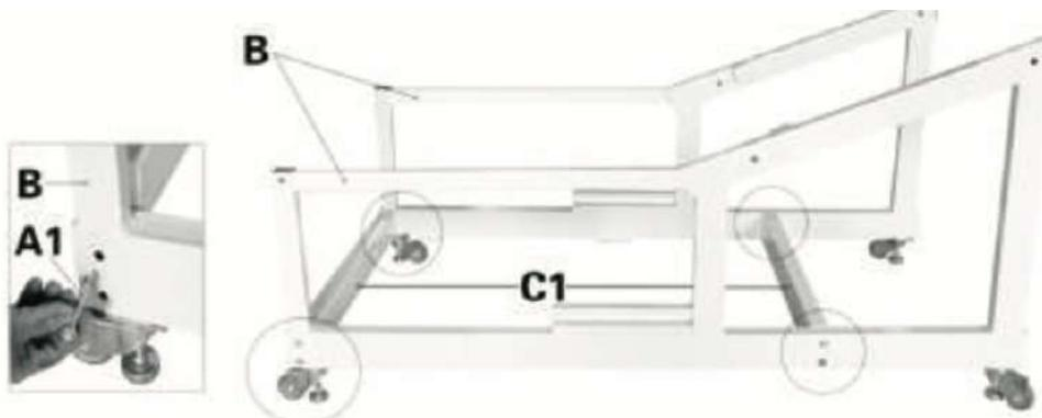
2. Закрепите нижнюю балку (С1) между опорными скобами (В) с помощью 8-ми винтов А1. Внимание: на этом этапе не затягивайте винты до конца, оставляя зазор для установки тяги пружины (D) и установочного винта пружины (Е) на шаге 4.
