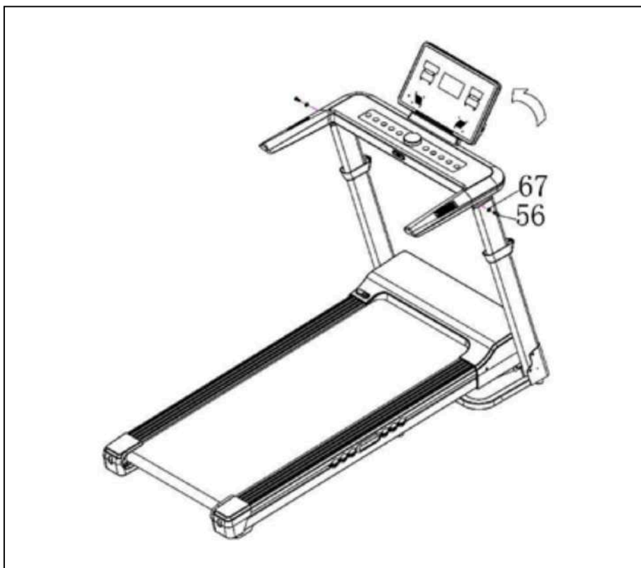
Рисунок 3 — Установка консоли беговой дорожки
