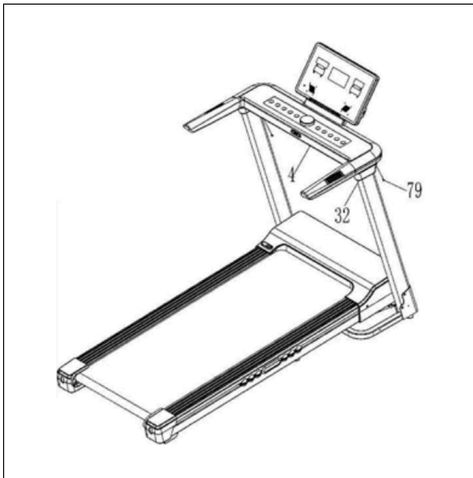
Рисунок 4 — Установка декоративных заглушек под консолью
