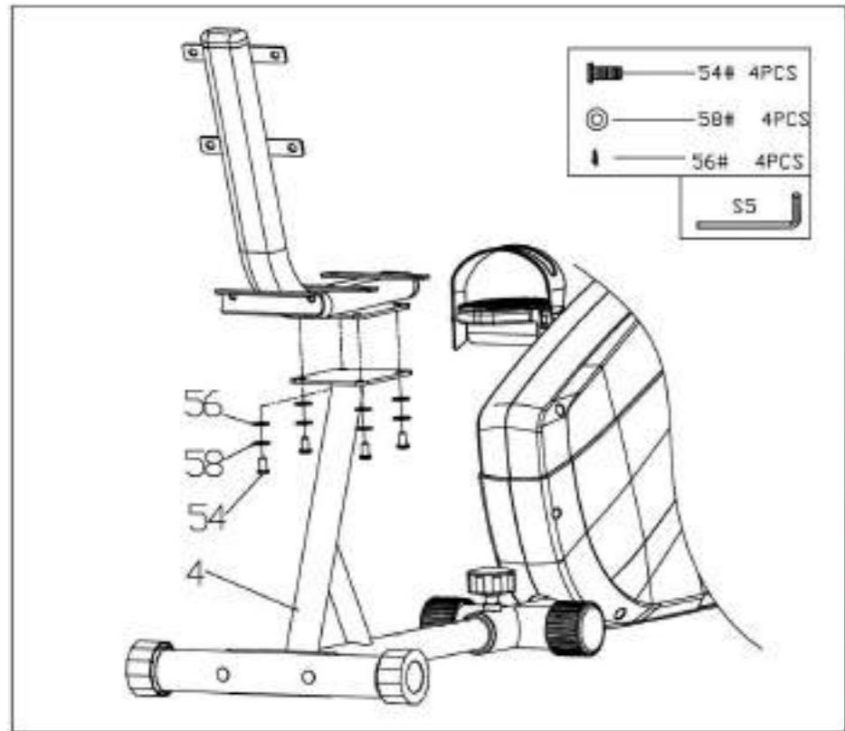
Прикрепите локтевую подставку (21) к задней стойке задней(4) с помощью винтов (54), шайб (56) и пружинных шайб (58)
