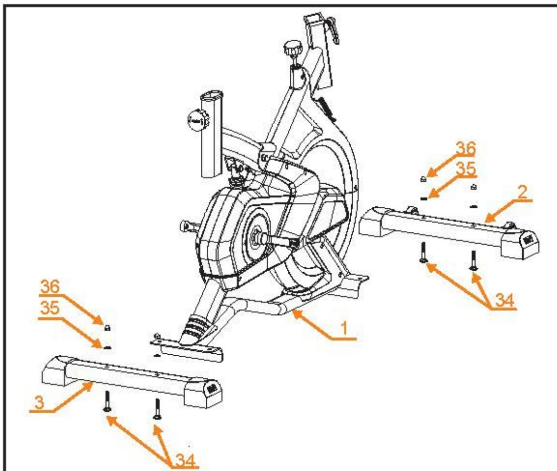
ПРИКРЕПИТЕ ПЕРЕДНИЙ (2) И ЗАДНИЙ (3) СТАБИЛИЗАТОРЫ К КОРПУСУ (1) ТРЕНАЖЁРА ПРИ ПОМОЩИ ЧЕТЫРЕХ КОМПЛЕКТОВ КРЕПЕЖА – ВИНТОВ (34), ШАЙБ (35) И ГАЕК (36).
