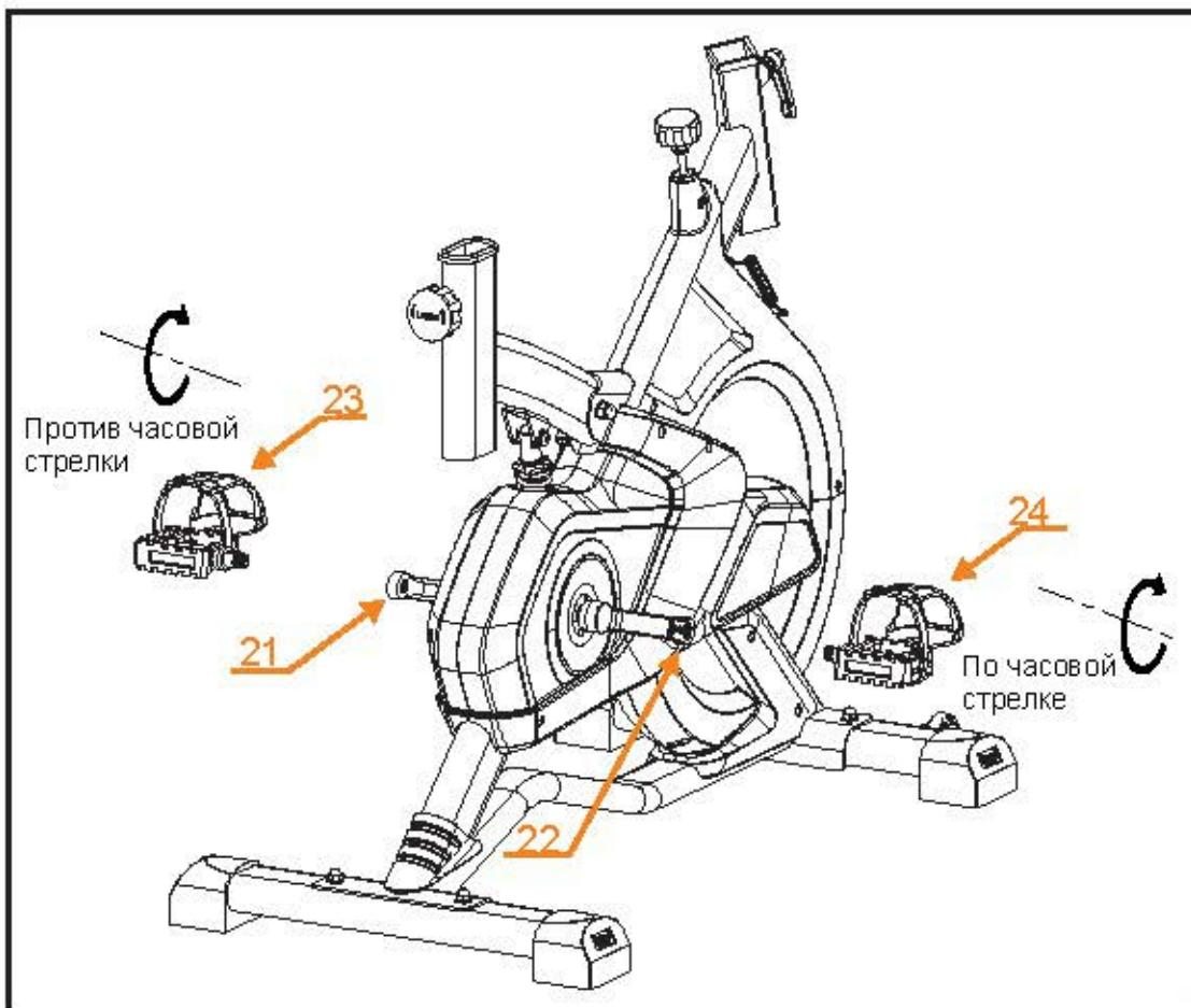
ПРИКРЕПИТЕ ЛЕВУЮ (23) И ПРАВУЮ (24) ПЕДАЛИ К СООТВЕТСТВУЮЩИМ КРИВОШИПАМ (21/22). ДЛЯ ТОГО, ЧТОБЫ ЗАКРУТИТЬ ПЕДАЛИ, СДЕЛАЙТЕ СНАЧАЛА 4-5 ОБОРОТА ВРУЧНУЮ, А ЗАТЕМ ОКОНЧАТЕЛЬНО ЗАТЯНИТЕ ПЕДАЛИ ГАЕЧНЫМ КЛЮЧОМ.
