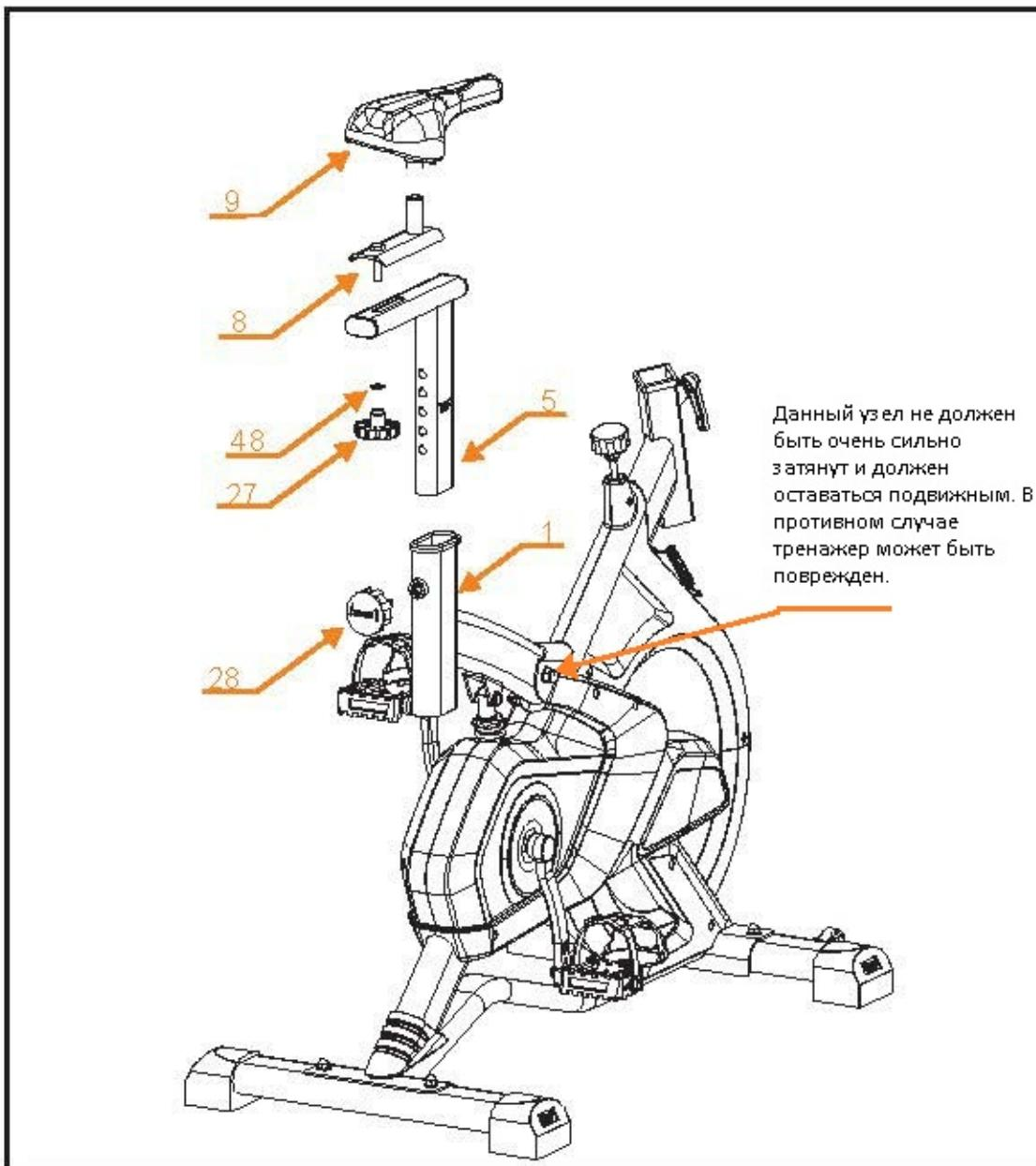
СНАЧАЛА ОТКРУТИТЕ РЕГУЛИРОВОЧНУЮ РУЧКУ (28) И СНИМите ЕЁ С ТРЕНАЖЁРА. ЗАТЕМ ВСТАВЬТЕ ДЕРЖАТЕЛЬ СИДЕНЬЯ (5) В КОРПУС (1) ТРЕНАЖЁРА, ОТРЕГУЛИРУЙТЕ ЕГО ПОЛОЖЕНИЕ И ЗАФИКСИРУЙТЕ, ЗАНОВО УСТАНОВИВ РУЧКУ (28). ПРИ ЭТОМ РУЧКА ДОЛЖНА ПОПАСТЬ В ОДНО ИЗ ОТВЕРСТИЙ НА ДЕРЖАТЕЛЕ, В ПРОТИВНОМ СЛУЧАЕ, КОНСТРУКЦИЯ НЕ БУДЕТ ПОЛНОСТЬЮ ЗАФИКСИРОВАНА.
