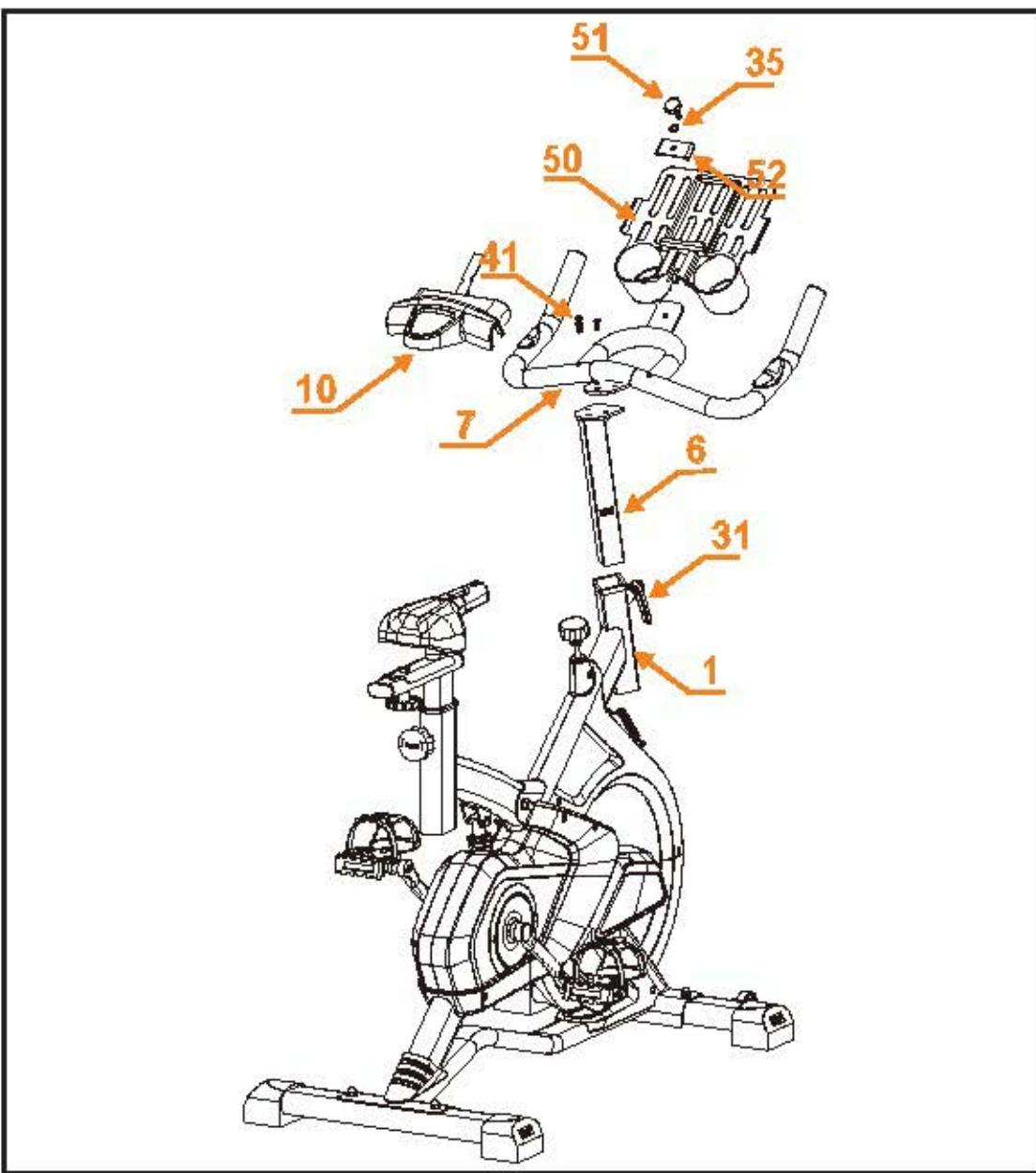
ОСЛАБЬТЕ ГАЙКИ, РАСПОЛОЖЕННЫЕ ПОД ДЕРЖАТЕЛЕМ ДЛЯ ТЕЛЕФОНА (10), И СНИМИТЕ ИХ С ПОРУЧНЯ (7). ЗАТЕМ ПРИКРЕПИТЕ ПОРУЧЕНЬ (7) К СТОЙКЕ (6), ИСПОЛЬЗУЯ ВИНТЫ (41), КОТОРЫЕ РАНЕЕ БЫЛИ ВЫКРУЧЕНЫ. ПОЛУЧЕННУЮ КОНСТРУКЦИЮ ПОДСОЕДИНЯТЕ К КОРПУСУ (1) ТРЕНАЖЁРА И ЗАКРЕПИТЕ ПРИ ПОМОЩИ ФИКСАТОРА (31).
