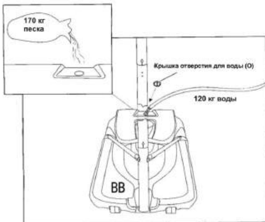
В целях безопасности рекомендуется наполнять основание песком, а не водой. При возникновении течи, вода может вытечь незаметно, в результате чего стойка может упасть, что может привести к травмированию и/или смерти или повреждению имущества. Устанавливайте основание только на ровную поверхность, очищенную от острых предметов, которые могут проколоть основание.
