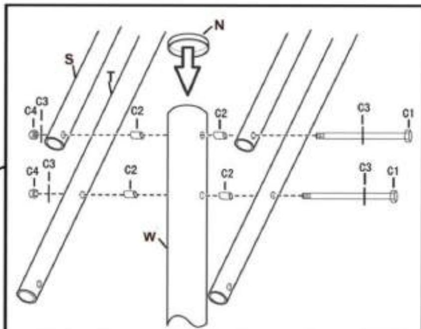
Установите опорные балки (S), (T), заглушку стойки (N) и механизм регулировки (Z), как показано на рисунке, и зафиксируйте их при помощи гаек.
