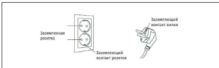
Рисунок 59 — Правильное заземление массажного кресла
