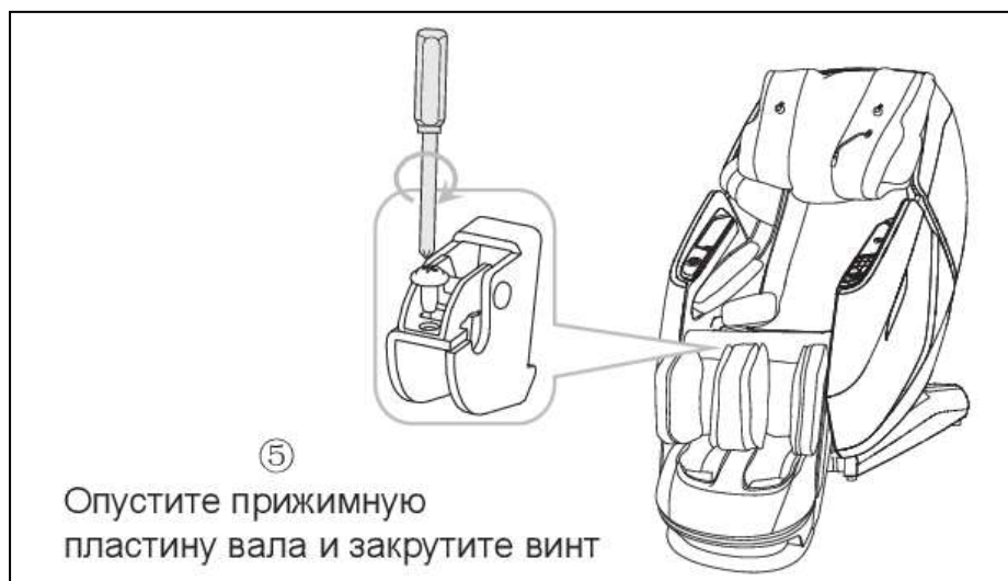
Рисунок 20 — Установка секции для ног
