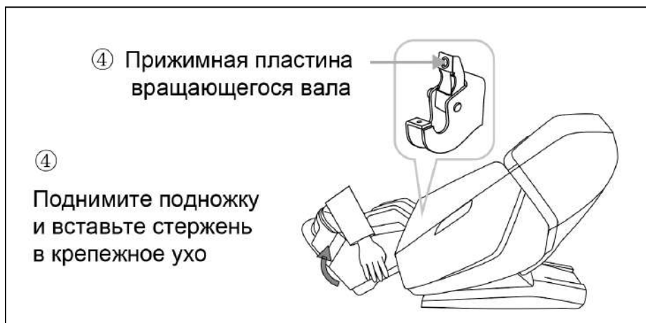
Рисунок 19 — Установка секции для ног
