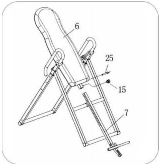
1. Потяните вверх пружинный штифт (15) и вставьте регулируемую штангу (7) в основную раму (6);
